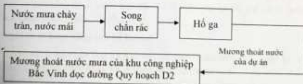
Hình 3.2: Sơ đồ thu gom, thoát nước mưa của Nhà máy may Minh Trí Vinh
